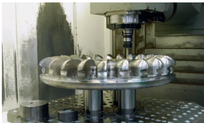
Roue taillée dans la masse en cours d'usinage
