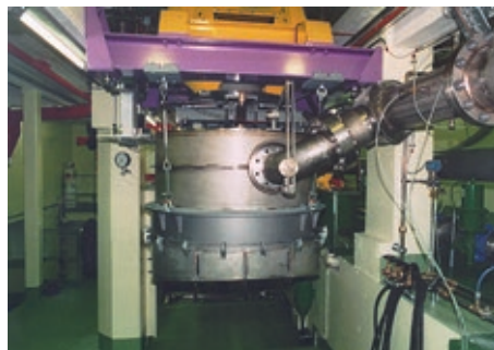
Turbine Pelton à deux injecteurs sur le stand d'essais en 1997
