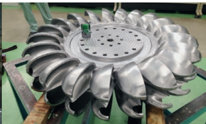
Roue taillée dans la masse de la turbine de Funama (Japon) ( Q = 0.586 \text{ m}^3/\text{s} , H_n = 205 \text{ m} , D_{ext} = 1026 \text{ mm} , 720 \text{ t/min} , P_m = 1170 \text{ kW} )
