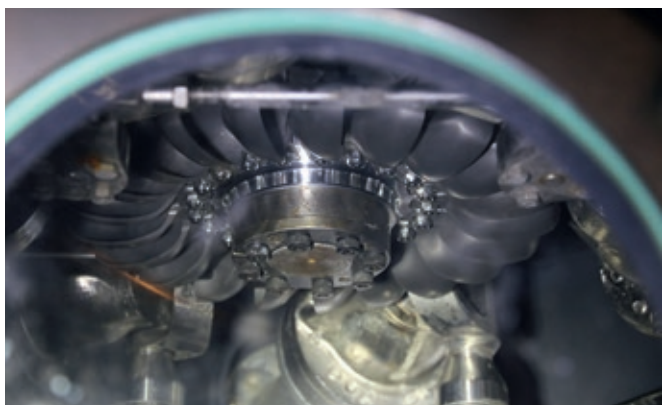
Roue du modèle réduit, à augets rapportés, testée par Mhylab sur son stand d'essais en 2015
